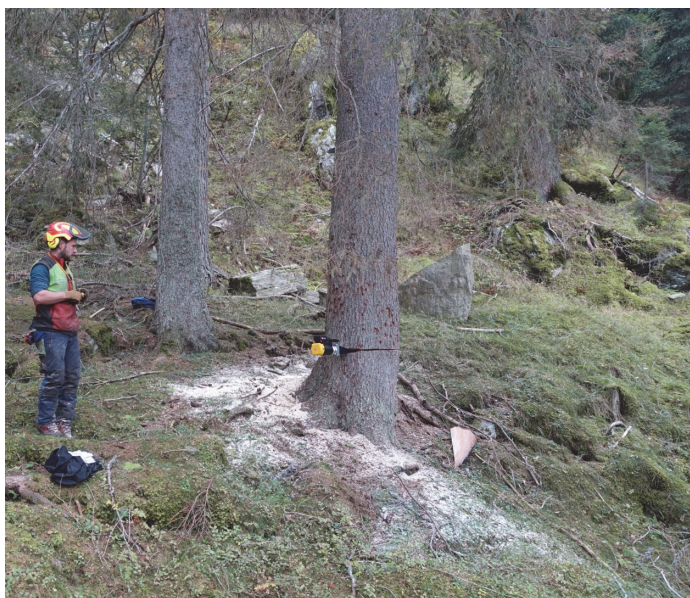
Foto 2 – Utilizzo del cuneo radio controllato nell'abbattimento di una pianta bostricata
