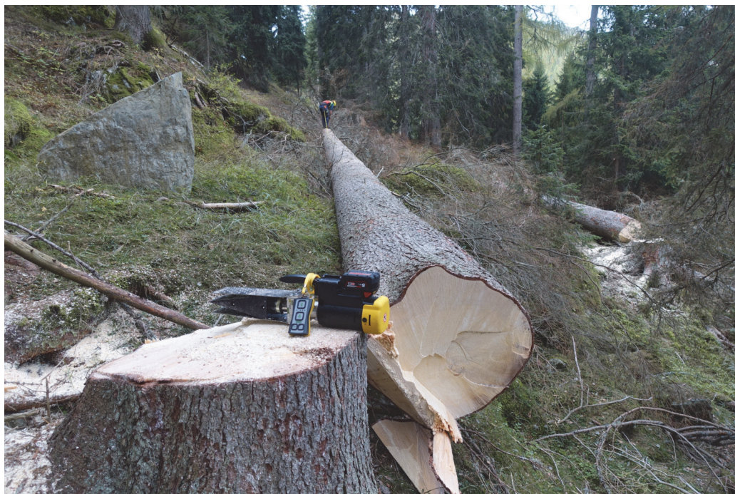
Foto 3 – Il cuneo di abbattimento radio controllato e relativo radio comando, attualmente in uso ad Aprofod
